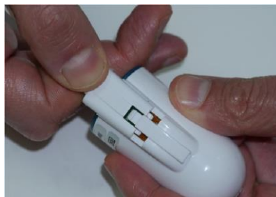
Afbeelding 23 – Aansluiten nieuwe vingersonde
