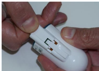
Figur 23 – Forbindelse af ny fingersonde
