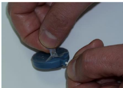
Figur 24 – Fjernelse af brystsensormærkat
