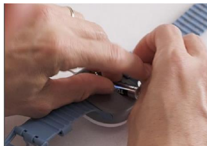
Figur 27 – Insetting av batteri
