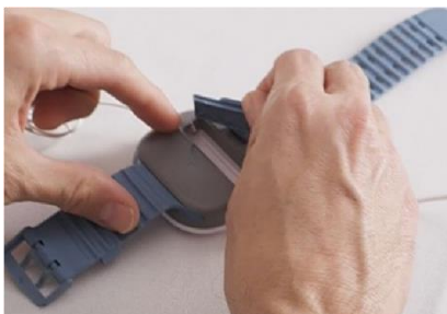
Figur 26 – Fjerning av batteri
