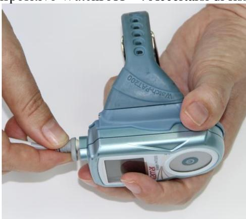
**Figura 18 – Sostituzione della sonda uPAT**
