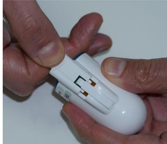
**Figure 23 - Nouvelle connexion du capteur de doigt**
