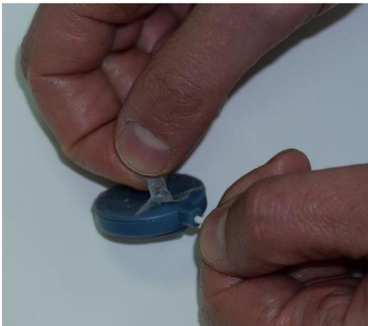
**Figure 24 – Retrait de l'autocollant du capteur thoracique**
