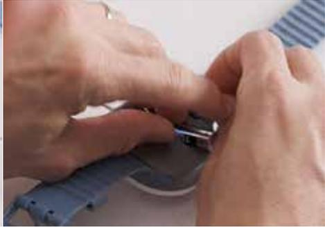
**Abbildung 29 – Einlegen der Batterie**
