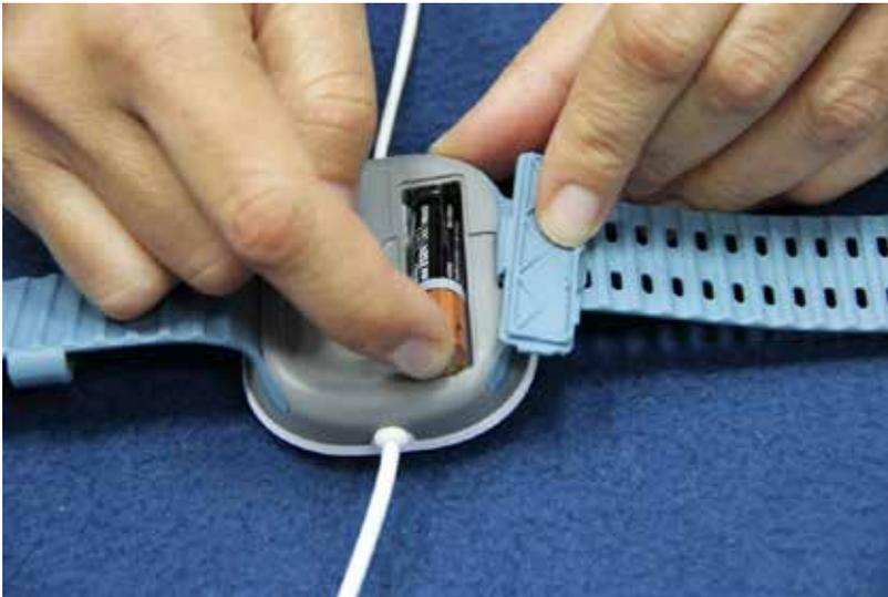
**Abbildung 4 – Einlegen der Batterie**
