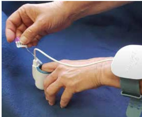
**Abbildung 8 - Entfernung der mit TOP bezeichneten Lasche mit Gegendruck gegen eine feste Unterlage**
