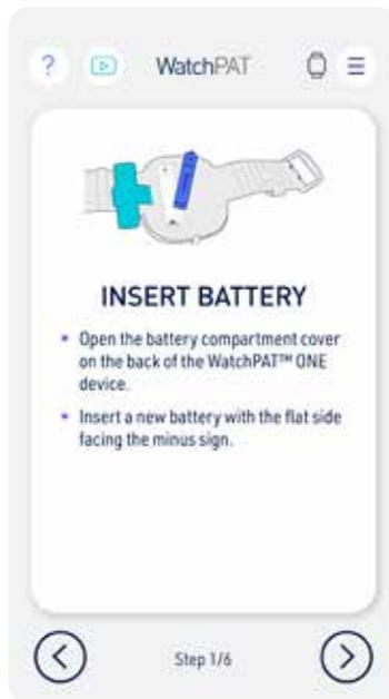
**Abbildung 14 – Bildschirmanzeige für das Einlegen der Batterie**
