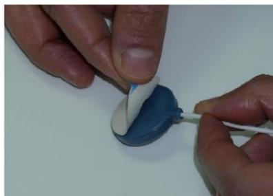
**Figura 25 – Fixação do adesivo do sensor torácico**
