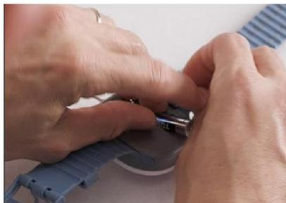
**Figura 27 – Colocação da pilha**
