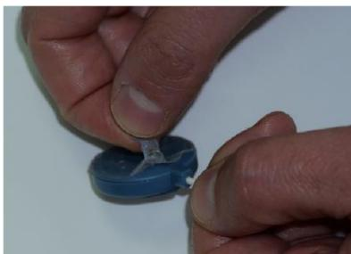
**Figura 24 – Remoção do adesivo do sensor torácico**
