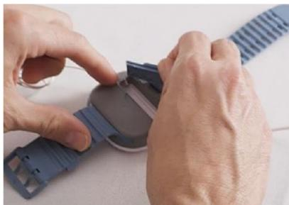
**Figura 26 – Remoção da pilha**
