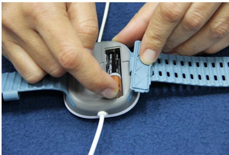
**Figura 4 – Colocação da pilha**
