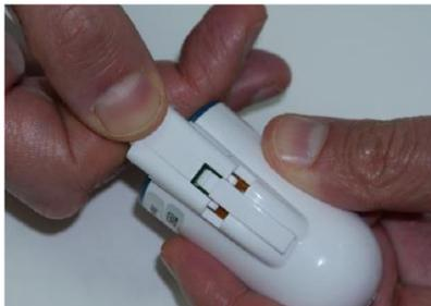
**Figura 23 – Nova ligação da sonda de dedo**
