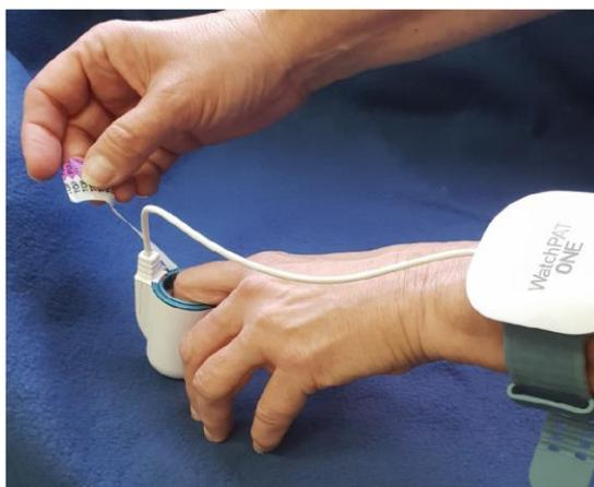
**Figura 8 – Retiro de la pestaña TOP mientras presiona contra una superficie dura**
