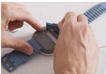
**Figura 26 – Retiro de la batería**
