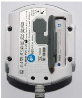
Figure 5 – Compartiment de la pile
